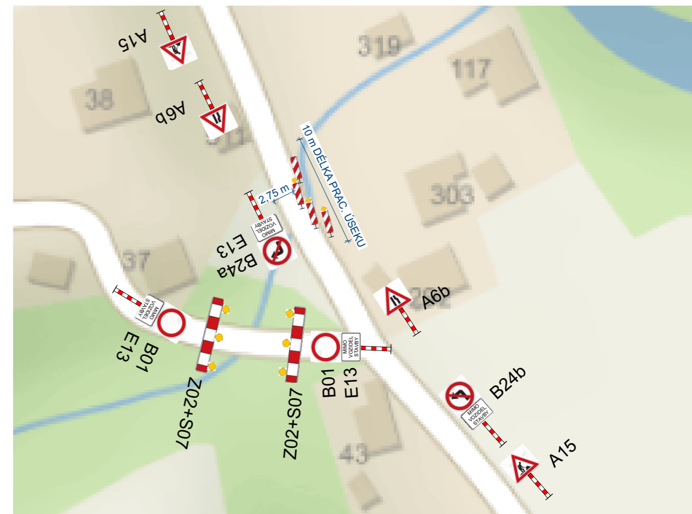
DETAIL DOPRAVNÍHO ZNAČENÍ V BLÍZKOSTI STAVBY
